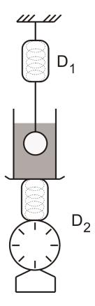
Ergue-se o conjunto constituído pela esfera e o dinamômetro  $D_1$ , até que a esfera fique totalmente fora d'água e aguarda-se que se reestabeleça o equilíbrio. A densidade da água é 1,0 kg/L. Considere g = 10 m/s².
