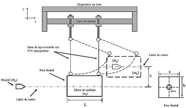
O teste foi realizado mantendo-se o bloco de madeira suspenso e parado. O projétil foi disparado por uma arma na direção horizontal, alinhada com a linha de centro, atingindo o bloco na face frontal, conforme esperado e mostrado na figura. O projétil possui uma massa ( $m_p$ ) e o bloco de madeira uma massa ( $m_b$ ). Ao atingir o bloco, a bala se manteve alojada e o deslocou a uma determinada altura “ $h$ ”, sem causar danos às hastes.
