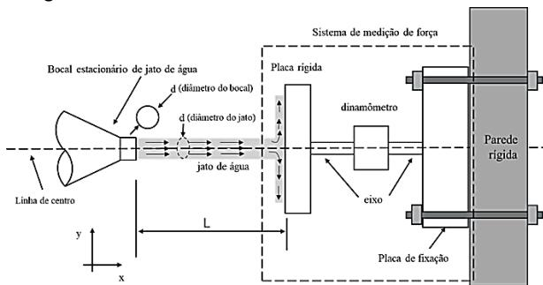
O diâmetro do jato é igual ao diâmetro do bocal ( $d$ ). O jato de água incidiu normal à placa rígida com velocidade  $V_j$  (m/s). Ao atingir a placa rígida, o jato de água se dividiu em parte iguais para cima e para baixo. No teste, o dinamômetro registrou uma força de 100 N na direção horizontal, coordenada x.
