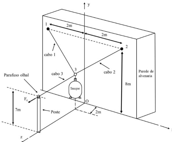
Foram colocados pontos de fixação na parede de alvenaria que estava próxima ao tanque e foi instalado um poste com olhal, por onde o cabo responsável em suspender o tanque irá passar (cabo 3). O supervisor da montagem, ao finalizar o seu serviço, solicitou que o engenheiro responsável determinasse as forças nos cabos 1 e 2, e a força  $F_c$ , responsável por suspender o tanque.
