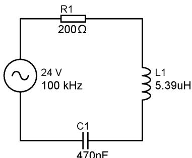
Observe os valores apresentados no esquema e determine impedância total do circuito.
