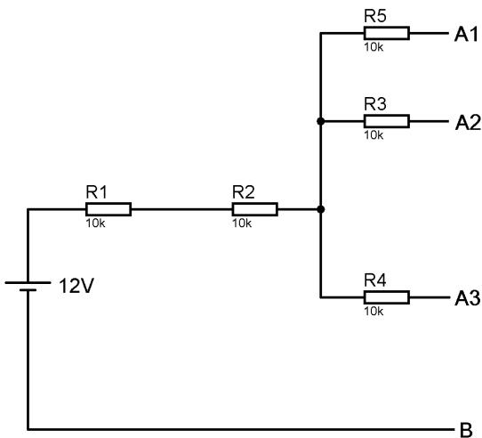
As tensões medidas entre o ponto A1 e o ponto B ( $V_{A1-B}$ ), entre o ponto A2 e o ponto B ( $V_{A2-B}$ ) e entre o ponto A3 e o ponto B ( $V_{A3-B}$ ) serão, respectivamente:
