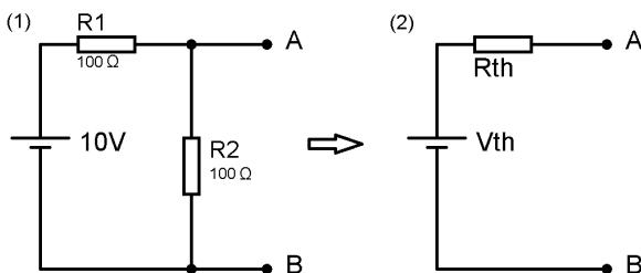
Calcule os parâmetros de equivalência de Thévenin do circuito 2, tensão e resistência de Thévenin (Vth e Rth), que uma carga perceberia se conectada entre os pontos A e B.
