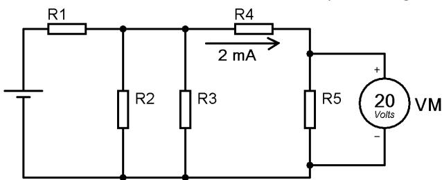
Analise o circuito e determine a resistência do resistor R5.
