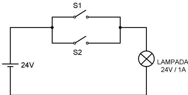
Sabendo que as chaves S1 e S2 (entradas) são do tipo NA e considerando a lâmpada acesa como nível lógico de saída alto e a lâmpada apagada como nível lógico de saída baixo, a função lógica implantada no CLP é uma
