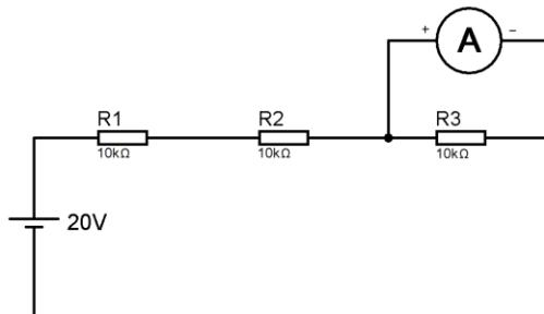
Sabendo que R1, R2 e R3 são resistores de 10 kΩ e considerando o princípio de funcionamento de um amperímetro ideal, a leitura de corrente mostrada no instrumento será de
