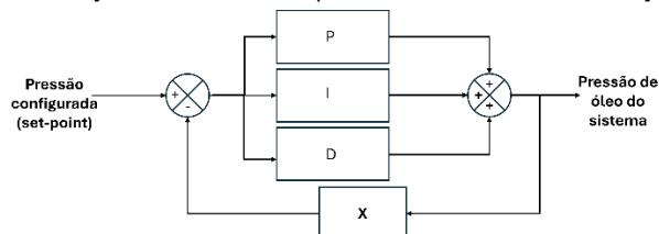
A partir do diagrama de blocos, de acordo com a teoria de controle PID, marque a opção que contém o componente correto a ser instalado no bloco indicado com a letra X.
