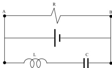
O circuito é composto por  $R = 30\Omega$ ,  $L = 30\text{H}$  e  $C = 3\mu\text{F}$ . Após a conclusão do regime transitório a fonte de tensão alimentará o mesmo com uma corrente elétrica total, em ampère, no valor de
