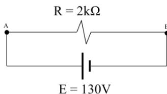
Esse circuito é responsável pela excitação do campo de uma máquina operatriz destinada ao corte de lâminas de aço.
