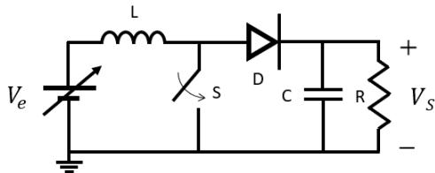
Considerando todos os componentes ideais e que o circuito opera no modo de corrente contínua (*Continuous current mode – CCM*), o valor de  $V_e$ , em volts, para que  $V_s = 50V$  é aproximadamente
