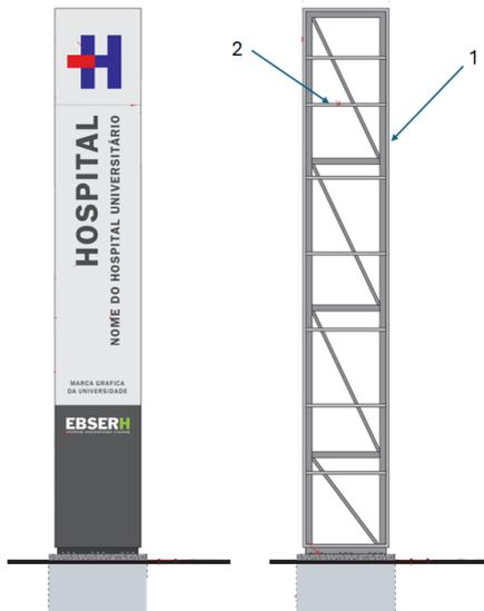
Na estrutura desse totem, o perfil metálico das faces (1) e os perfis metálicos de contraventamento (2) são, respectivamente, do tipo
