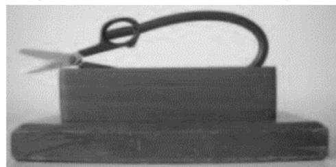
Figura 2 – Tesoura adaptada em suporte fixo
