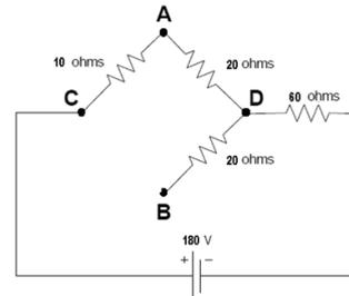
O equivalente de Norton visto entre os pontos C e B da figura acima é composto por uma fonte de corrente e um resistor de, respectivamente,
