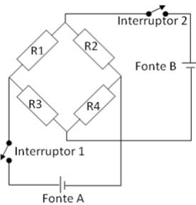
Ao ligar simultaneamente os interruptores 1 e 2, verifica-se que a tensão no resistor R1 é igual a zero. Nesta situação a tensão no resistor R3 será igual a
