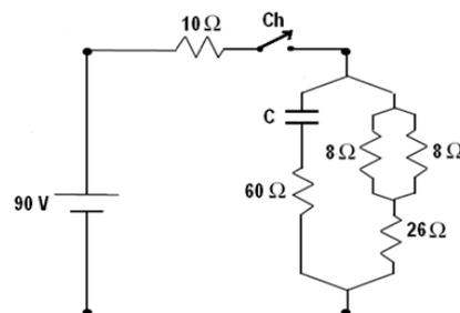
Para o circuito elétrico da figura acima, a corrente elétrica que flui pelo resistor de  $60 \Omega$ , imediatamente após o fechamento da chave Ch, e a corrente que flui pelo resistor de  $26 \Omega$  para o circuito em regime permanente são, em Ampères, respectivamente iguais a
