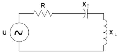
Sabendo-se que a fonte tem uma tensão eficaz de 90 V e que  $R$ ,  $X_C$  e  $X_L$  são iguais a  $10 \Omega$ , a potência elétrica, em watts, envolvida nesse circuito é de
