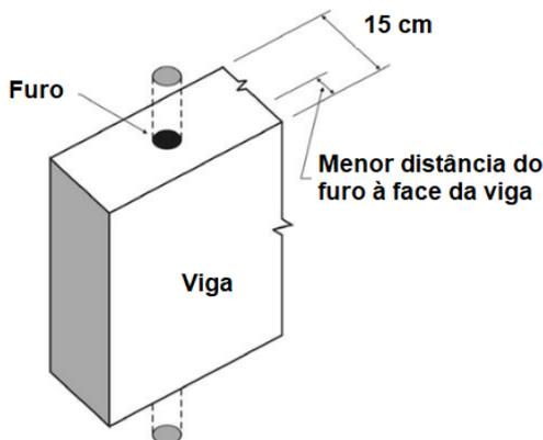
Sabendo-se que a viga possui 15cm de largura e cobrimento de 2,5cm, o maior diâmetro possível para essa tubulação é de
