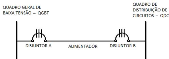
A fim de coordenar a proteção, as curvas mais adequadas dos disjuntores A e B devem ser:
