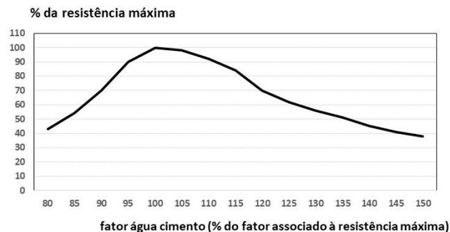
Sabe-se que o fator água cimento ótimo desse concreto é de 0,40. Entretanto devido a falhas no controle tecnológico durante a preparação da mistura, utilizou-se um fator água-cimento de 0,45. Como consequência, a resistência final a ser atingida pelo concreto será de aproximadamente
