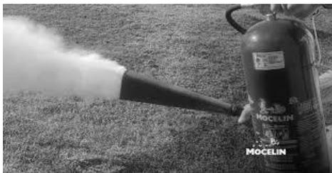
O gás  $\text{CO}_2$  de um extintor de incêndio é mais denso do que o ar. À medida que o  $\text{CO}_2$  sai do extintor, resfria-se significativamente. O vapor d'água no ar é condensado pelo  $\text{CO}_2$  frio e forma uma nuvem branca.
