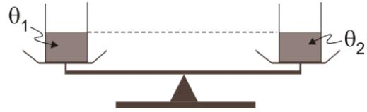
No prato da esquerda, o líquido está na temperatura  $\theta_1$  e, no da direita, na temperatura  $\theta_2$ . Verifica-se que a balança só permanece em equilíbrio quando se coloca um contrapeso no prato da esquerda.
