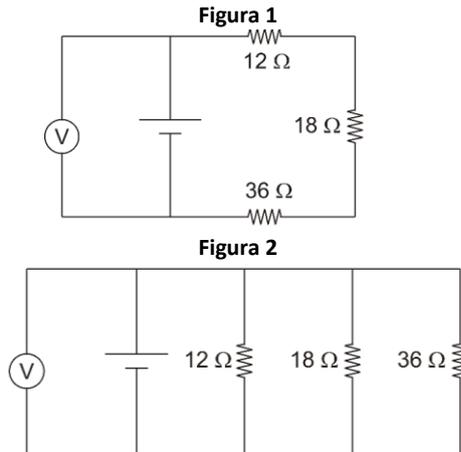
Em ambos os casos, a indicação do voltímetro ideal é a mesma. Sendo assim, a razão  $P_2/P_1$  entre as potências consumidas nas situações ilustradas na fig. 2 ( $P_2$ ) e na fig. 1 ( $P_1$ ) é igual a
