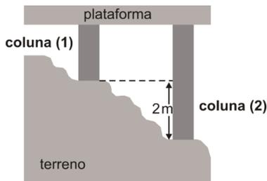
O coeficiente de dilatação linear do material da coluna (1) é  $2,4 \cdot 10^{-5} / ^\circ\text{C}$ , e o do material da coluna (2) é  $8 \cdot 10^{-4} / ^\circ\text{C}$ . Para que a plataforma permaneça horizontal, seja qual for a variação de temperatura, os comprimentos iniciais das colunas (1) e (2), devem ser, respectivamente,
