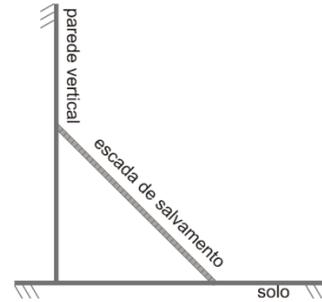
Considere:  $\vec{P}$  – Força peso,  $\vec{F}_{at\ s}$  – Força de atrito entre a escada e o solo,  $\vec{F}_{at\ p}$  – Força de atrito entre a escada e a parede,  $\vec{N}_s$  – Força Normal ao solo e  $\vec{N}_p$  – Força Normal à parede.
