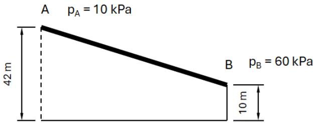
No ponto A, a pressão  $p_A$  é de 10 kPa, enquanto, no ponto B, a pressão  $p_B$  é de 60 kPa. Além disso, o diâmetro da tubulação em A é o dobro do diâmetro em B.
