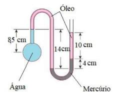
Sabe-se que o peso específico da água é de  $\Upsilon_{\text{água}}$  = 9.800 N/m³, o peso específico do óleo é de  $\Upsilon_{\text{óleo}}$  = 7.800 N/m³ e o peso específico do mercúrio é de  $\Upsilon_{\text{Hg}}$  = 133.500 N/m³.
